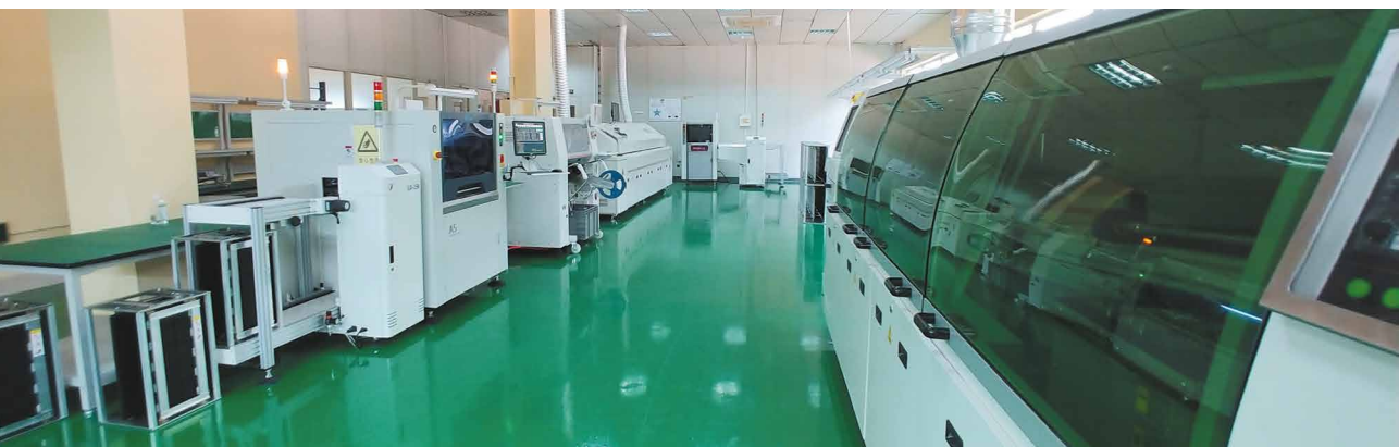
КИТАЙ, СУЧЖОУ. Автоматическая линия по SMT и DIP монтажу компонентов
